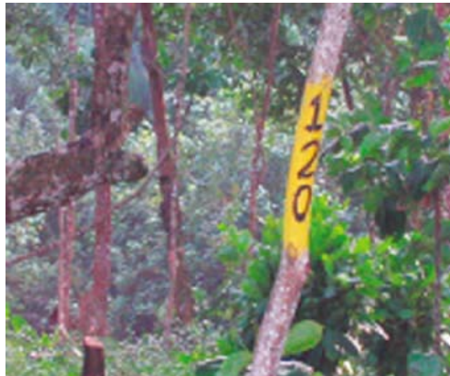
Figura 11. Los mojones pueden ser piezas de madera o árboles que son enumerados según el protocolo, de manera creciente en sentido norte-sur.
