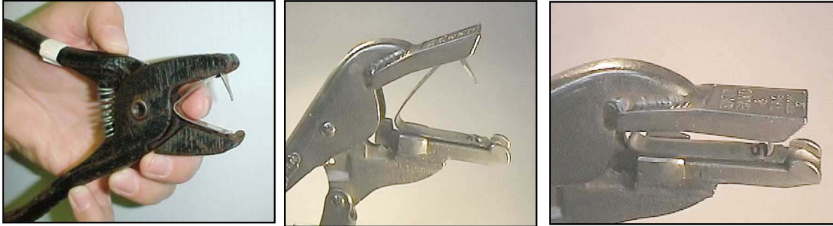
Figura 8. Marca metálica externa Monel tipo 1005-49 correctamente colocada (izquierda) y cerrada en el aplicador (derecha). Note que la punta afilada quede enganchada en el punto de cierre. Fuente: http://www.nationalband.com/nbt.pdf
